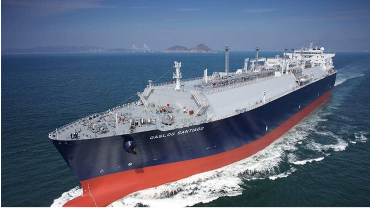
Methanier à membrane
