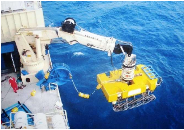
Déploiement du Rovjet 402 du câblier Île de Ré pour une inspection sous-marine d'un câble en 2009. (Photo : C/V Île de Ré)
