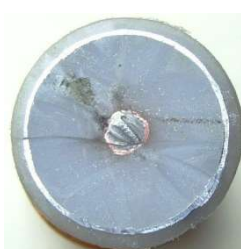
Câble coaxial ARIANE France - Crète de 1974. Diamètre = 45,0 mm.
