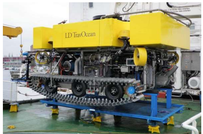
Le ROV type Rovjet 400 de LD Travocéan utilisé sur les navires d'ASN gérés par LDA. À gauche, sous sa grue de mise à l'eau et à droite à son poste de mer sur le pont d'un câblé. Peut opérer jusqu'à 2500 m de profondeur. Poids dans l'air : 10 tonnes. Équipé de 8 propulseurs. Puissance 300 kW. Vitesse sur chenilles : 2 500 m/h. (Photos : LDTVO et IT)
