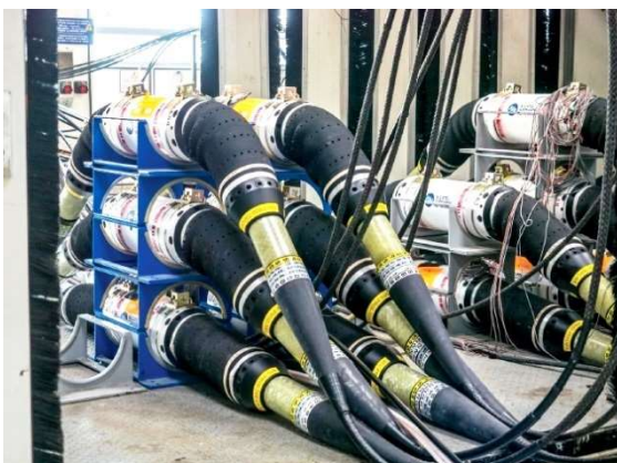
À gauche, stockage de répéteurs dans l'espace dédié du hangar d'un câblier ASN. À droite, déploiement d'un répéteur lors de la pose d'un câble.
