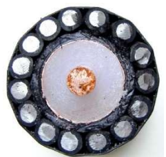
Câble coaxial Marseille - Beyrouth de 1970, avec armure. Probablement une section réparée avec un câble plus protégé. Diamètre = 48,0 mm.
