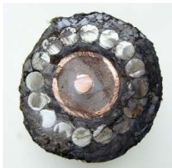
Câble coaxial Mazara (Sicile) - Pantelleria (île italienne) - Kélibia (Tunisie) de 1956. Diamètre = 35,0 mm.
