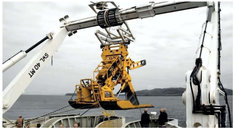
La charrue Elodie d'Orange. Elle peut travailler jusqu'à 2000 m de profondeur et ensouiller jusqu'à 3 m. Poids de 31 tonnes. Elle est articulée pour pouvoir ajuster la profondeur d'ensouillage en fonction de la nature du fond et repose sur deux patins. À l'arrière, un bras permet d'appuyer le câble dans le sillon. (Photo : Orange Marine)
