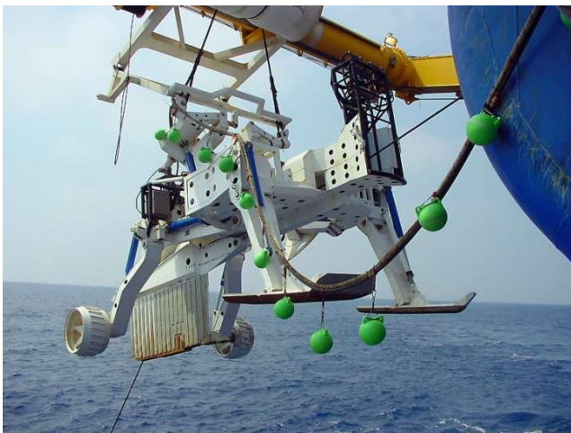
La charrue Elodie d'Orange. Elle peut travailler jusqu'à 2000 m de profondeur et ensouiller jusqu'à 3 m. Poids de 31 tonnes. Elle est articulée pour pouvoir ajuster la profondeur d'ensouillage en fonction de la nature du fond et repose sur deux patins. À l'arrière, un bras permet d'appuyer le câble dans le sillon. (Photo : Orange Marine)
