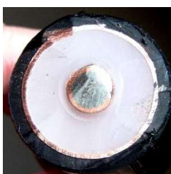
Câble coaxial Marseille - Beyrouth de 1970. Diamètre = 31,3 mm.
