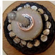
Câble à fibres optiques SeaMeWe 2 (South-East Asia - Middle East – Western Europe 2) à 3 paires de fibres, de 1994. Ici, une section à simple armure. (Câble relevé au printemps 2009 par le câblier Île de Bréhat en Méditerranée pour la préparation de la pose du câble TE-N. Photo Y-N. Massac).
